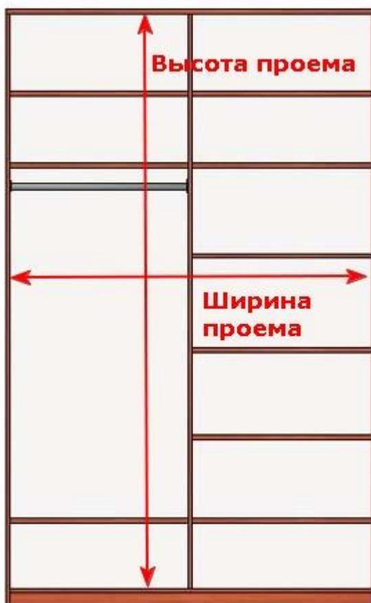
**Рис. 1.** Проем для установки дверей купе
